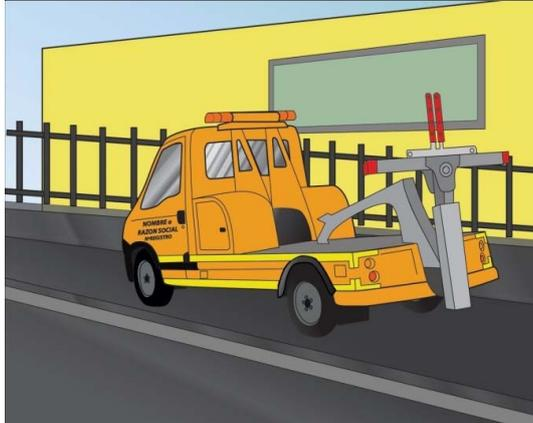
4. **Grúa para motocicletas.** Acondicionada interiormente, con equipo de carga y descarga, sujeción y amarre.
